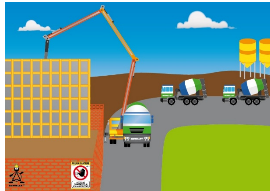
[esempio di scarico all'esterno del cantiere]
