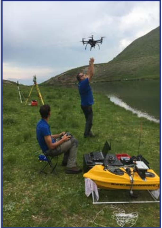
Udine - Rilievi Aerofotogrammetrici e Batimetrici
