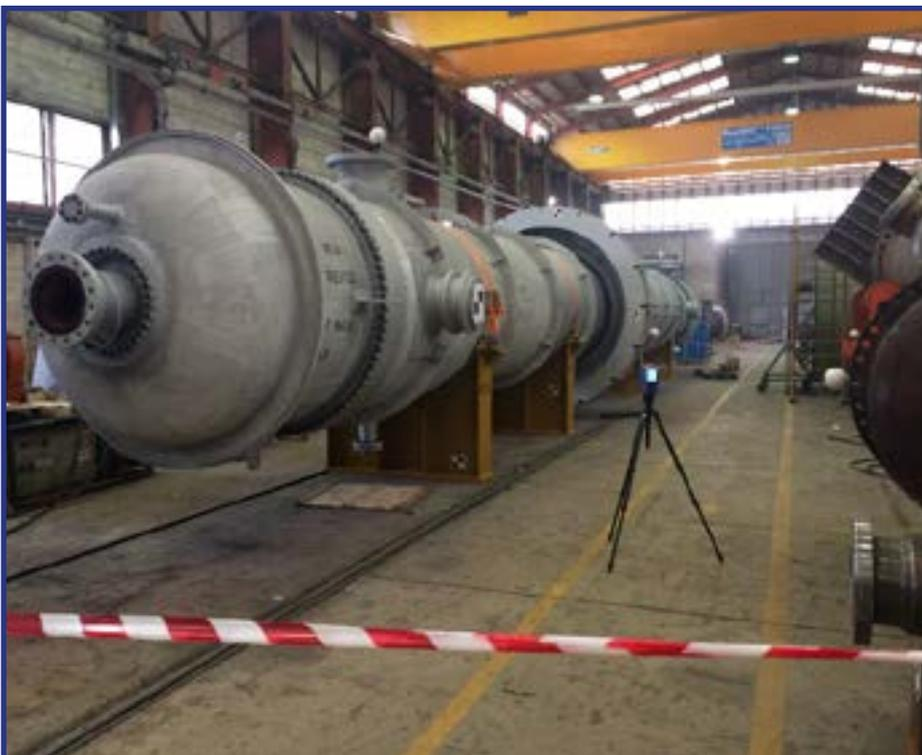
Rilievo Laser Scanner Scambiatore Nucleare
